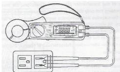
**Precaución.** Antes de tomar ninguna medición de una resistencia interna de un circuito, desconecte el circuito a medir y descargue completamente todos los capacitadores.
