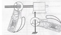
**1. Medición de corriente de un conductor tierra.**
